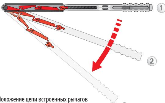
**1** Положение цепи встроенных рычагов без воздействия силы (в начальной позиции).
