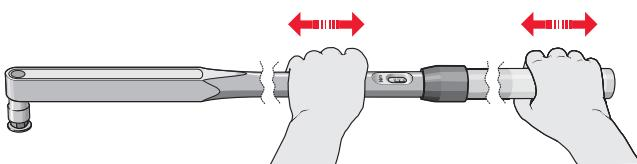
будет достигаться точно без изменения. Благодаря уникальному одноосевому расположению центра вращения и внешнего приводного квадрата, DREMOMETER - это инструмент, который работает без ошибок. В отличие от обычных динамометрических ключей, данный одиночный рычаг позволяет осуществлять затягивание без отклонений в измеренном значении и без воздействия на точность, вызванного приложением к инструменту усилия за пределами рукоятки.
